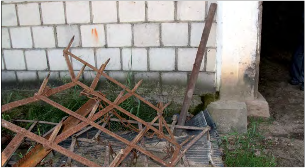
Fot. 6. Czy wiesz, dlaczego ta brona stwarza zagrożenie? Jest źle odłożona. Osoba wychodząca z budynku mogłaby potknąć się na nierównej nawierzchni i upaść na jej ostrza. Maszyny i narzędzia takie, jak to, należy kłaść zawsze ostrymi elementami do dołu i przechowywać w wyznaczonych do tego miejscach.
